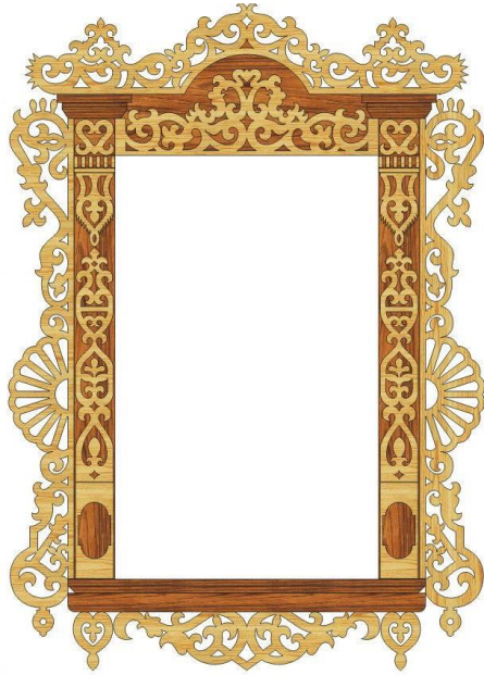
Рис. 3. Вариант наличника с основой и пропильными элементами
